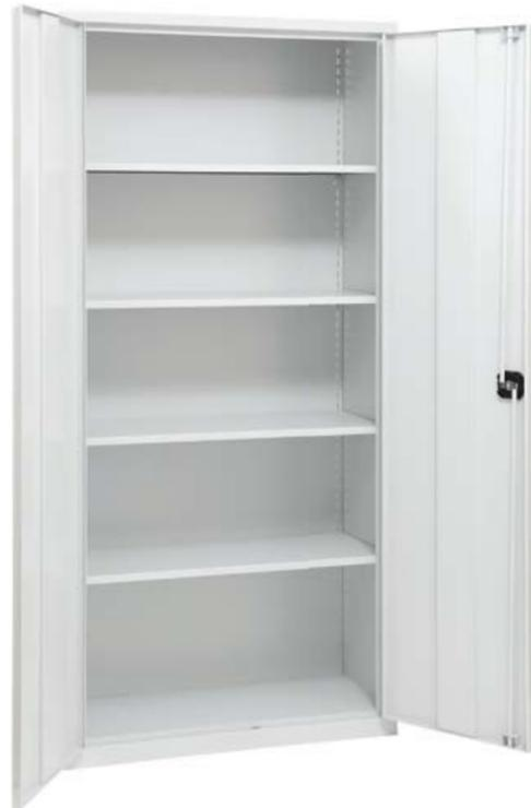
**Korpus:** Konstruktion aus elektrolytisch verzinktem Stahlblech 0,75 mm stark. Durch spezielle Umbüge der Holme, Seitenwände und Rückwand, sowie punktversteifte Verbindungen wird eine hohe Stabilität erreicht. Die 20 mm negativ eingebaute Rückwand gewährt eine zusätzliche Steifigkeit und hemmt eventuelle Schimmelbildung hinter dem Schrank.
